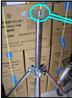
② ねじを外して投光器本体を取り付けてねじ止めします
