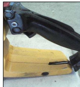
A：セーフティーレバーとB：スロットルレバーを握りながらC：ロックピンを押し込み、手を離すとスロットルレバーの固定が完了します。
