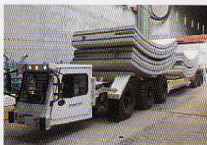
輸送車両(MSV)でセグメントを運搬する様子
